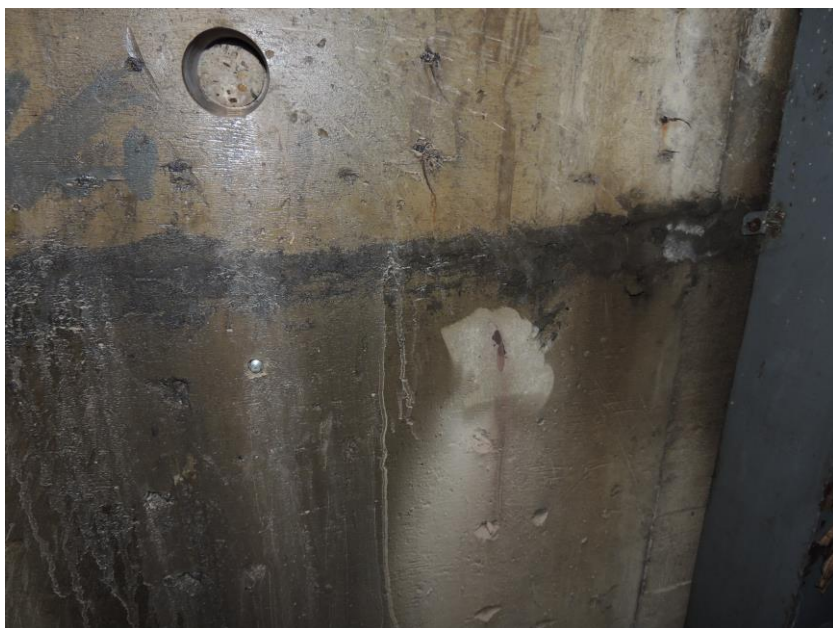
Zkušební místo pro stanovení pevnosti betonu Schmidtovým tvrdoměrem
