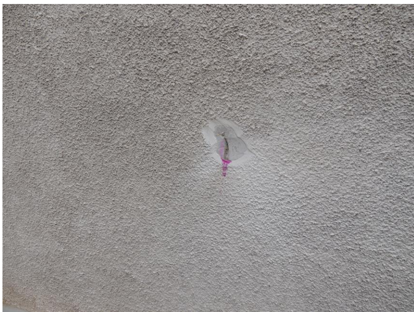
Zkušební místo pro stanovení pevnosti betonu Schmidtovým tvrdoměrem a hloubky karbonatace betonu
